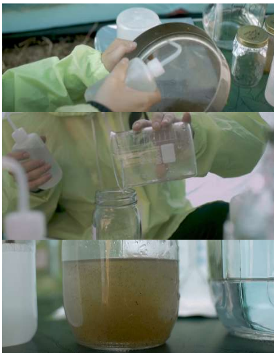
Рисунок 2. А) Промывка сита; Б) Перенос пробы в стеклянную банку; В) Готовая проба воды с органической взвесью.
